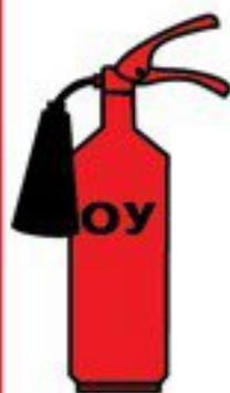
Предназначен для тушения пожаров различных веществ в том числе в электроустановках находящихся под напряжением до 1000 вольт.
